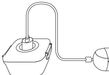
本体の左側にあるチューブ差込口にキャニスター用チューブのとがっている部分を差し込む。
